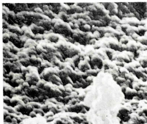
Obr. 6. Variabilné rozmery sfér v sklenom opáli. Leptaný povrch (svetlá časť na povrchu je artefakt). Rastrovací elektrónový mikroskop, zv. 30 000×
