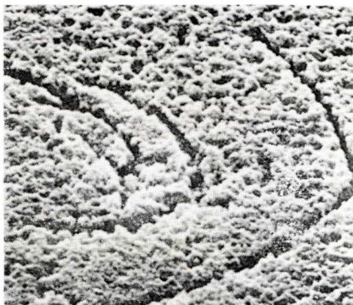
Obr. 11. Rez špirálou rastu (?) v mliečnom opáli. Leptaný povrch. Rastrovací elektrónový mikroskop, zv. 5000 \times
