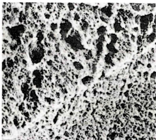
Obr. 9. Pórovitá textúra mliečneho opálu. Zóny s rozdielnou veľkosťou sfér. Leptaný povrch. Rastrovací elektrónový mikroskop, zv. 2000×
