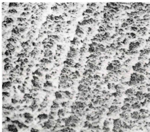
Obr. 10. Tlakové usmernenie sfér v mliečnom opáli. Leptaný povrch. Rastrovací elektrónový mikroskop, zv. 2000×
