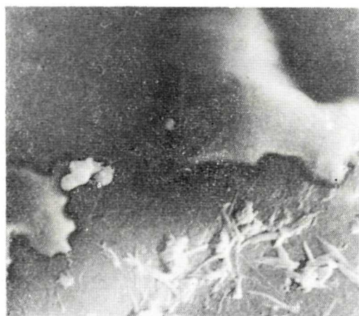
Obr. 13. Uzavrenny cudzích fáz v drahom opáli. Lomová plocha. Rastrovací, elektrónový mikroskop, zv. 12 000×
